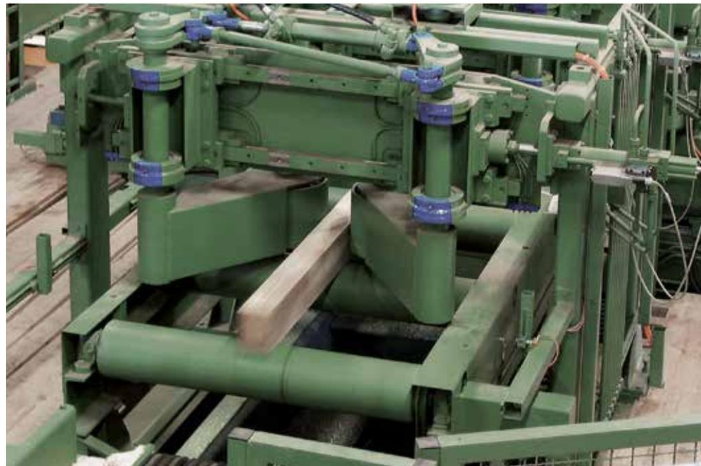
Kantholz mit vier profilierten Seitenbrettern kurz vor dem Separieren: Die fertige Seitenware gelangt über Transporteinheiten in das Sortierwerk, das Kantholz wird im weiteren Prozess zu Hauptware aufgetrennt.
