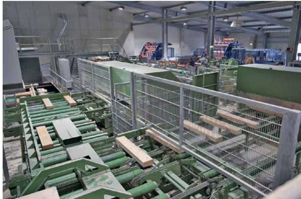
In der Profilieranlage können Rundhölzer mit einer Länge ab 1,20 m eingeschnitten werden. Die Hölzer werden mit 2,50 m aufgegeben und mit einer Kappsäge mittig getrennt. Bei Produktion von Schnittholz mit einer Länge von 2,50 m werden Kappsäge und Spaltkeil nach unten geschwenkt.
