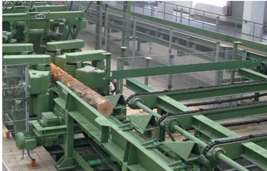
Einzugsseite der Spaner-Kreissägekombination mit automatischer Stammzuführung. Die Eindrehung der Rundhölzer erfolgt vollautomatisiert anhand der 3D-Messdaten.
