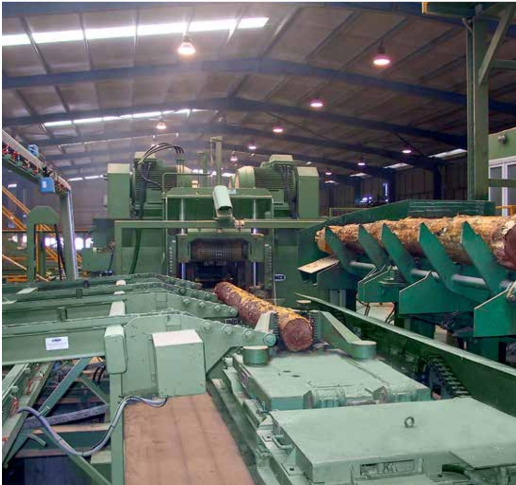
Blick vom Spannwagen in Richtung Sägeaggregat – rechts die Zubringung der Rundhölzer, links Einspeisung der Model und Kanthölzer für den zweiten und dritten Durchlauf.
